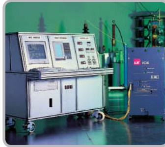
Проверка характеристик вакуумного автоматического выключателя
