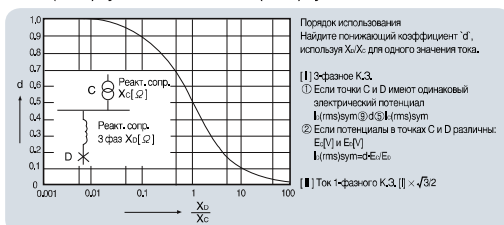
Рис. 9. Понижающий коэффициент, учитывающий уменьшение тока К.З., вызванное реактивным сопротивлением d
