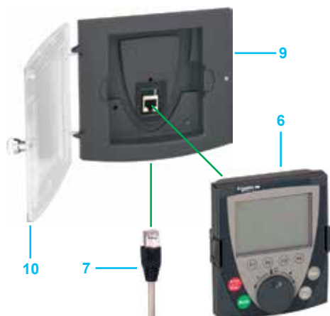
Использование выносного графического терминала на двери шкафа: 6 + 7 + 9, если IP 54, 6 + 7 + 9 + 10, если IP 65
