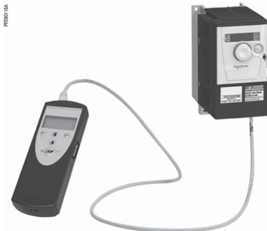
Конфигурирование преобразователя ATV 312 с помощью мультизагрузчика
