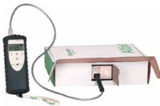
Конфигурирование преобразователя частоты Altivar 32 в заводской упаковке: мультizaгрузчик VW3 A8 121 + кабель VW3 A8 126
