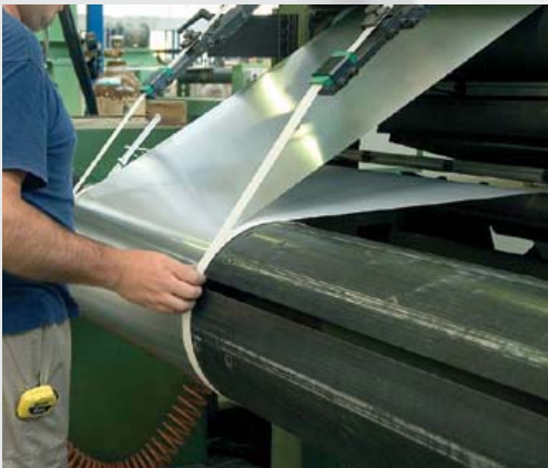
Намотка обмотки низкого напряжения
