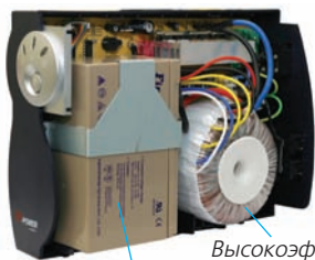
Высокоэффективный тороидальный трансформатор
