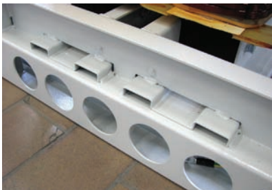
Дополнительные ребра жесткости существенно укрепляют конструкцию
