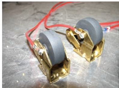
Последняя модификация долговечных графитовых роликов с большим сроком службы (не менее 10 лет)
