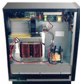
Изолирующий трансформатор, аккумуляторные батареи снизу в лотке
