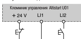
Схема 3-проводного управления
