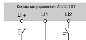
Схема 3-проводного управления
