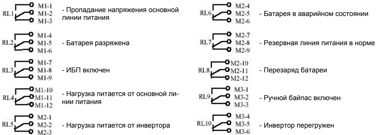
РИСУНОК 7: ОПИСАНИЕ ОТКРЫТЫХ КОНТАКТОВ РАЗЪЕМА DB9.
